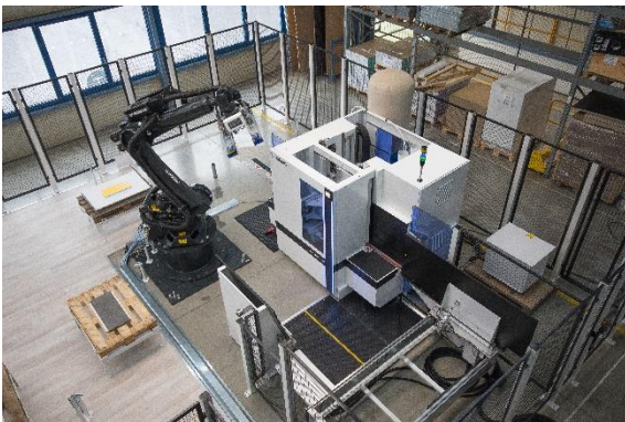
Image 1 : les modèles DRILLTEQ V-500 et FEEDBOT D-300 forment une cellule de fabrication efficace.
