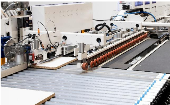
Image 4 : système d'alimentation de pièces WZ14 en nouveauté sur l'EDGETEQ S-500.
