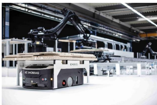
Рис. 11: Каждая тележка TRANSBOT с помощью навигационного лазерного сканера регистрирует присутствие людей и объектов на пути перемещения, повышая таким образом уровень безопасности производства.
