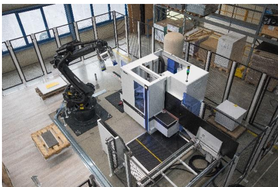
Bild 1: DRILLTEQ V-500 und FEEDBOT D-300 bilden im Zusammenspiel eine effizient produzierende Fertigungszelle.
