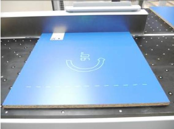
Das HOLZMA System führt den Maschinenbediener visuell – bspw. mittels Laserprojektionen auf dem Werkstück
