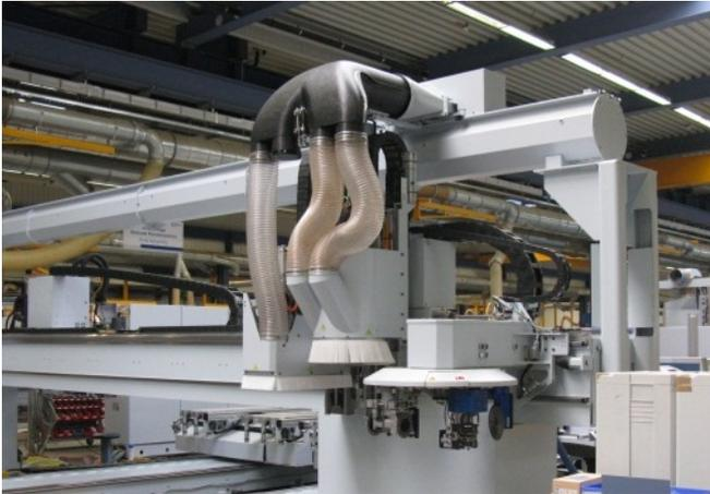
**Die neue störungsoptimierte Absaughaube bei HOMAG CNC-Maschinen**
