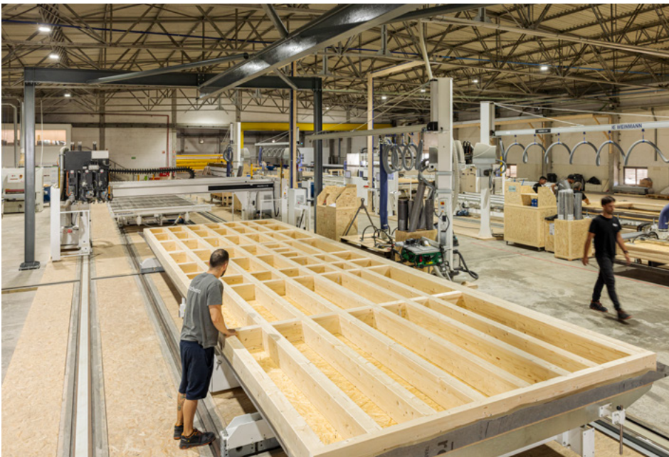
Fotos: Utilização de sistema de recorte, mesas de montagem e pontes multifunções na fábrica da Kōzōwood.
