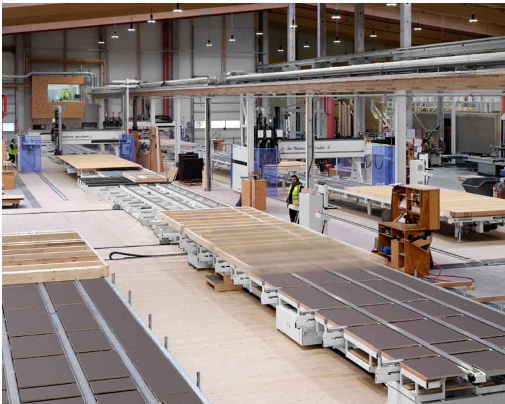
Fotos: Paralelamente à linha de produção, o elemento estrutural é elaborado em duas mesas de elementos e, em seguida, processado pela ponte multifuncional.
