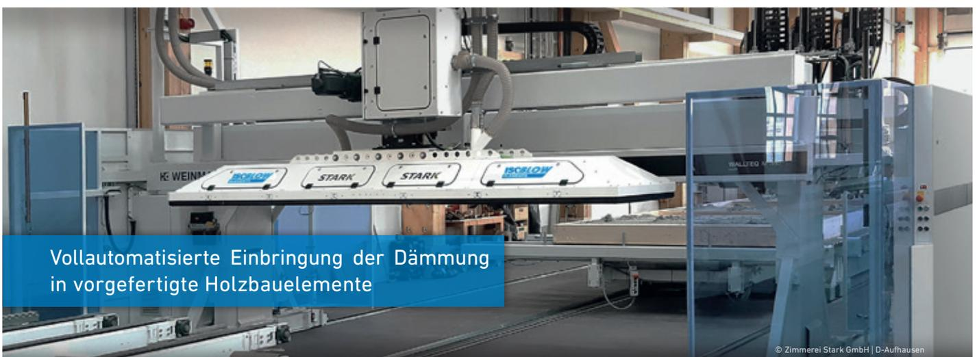
Vollautomatisierte Einbringung der Dämmung
