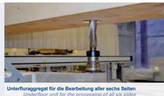
Unterfluraggregat für die Bearbeitung aller sechs Seiten
