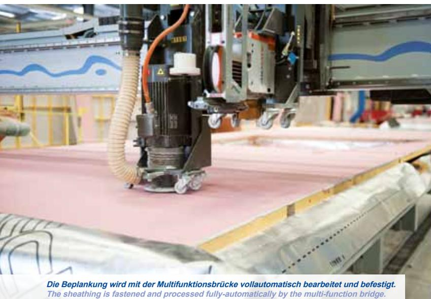
Die Beplankung wird mit der Multifunktionsbrücke vollautomatisch bearbeitet und befestigt.
