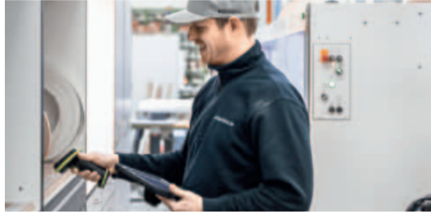
Das Ein- und Auslagern der Kanten erfolgt per Tablet und Handschanner. Alle Kanten sind geordnet und aufgeräumt.
