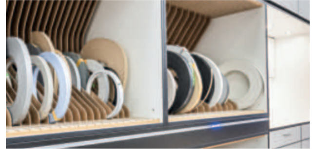
Blau leuchtende LED-Leisten am Kantenregal zeigen exakt an, wo die gewünschte Kante zu finden ist.
