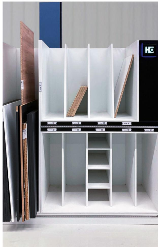
Reststücke mit System: Das Handresteregal sorgt für Übersicht, Ordnung und maximale Materialnutzung direkt an der Maschine.
