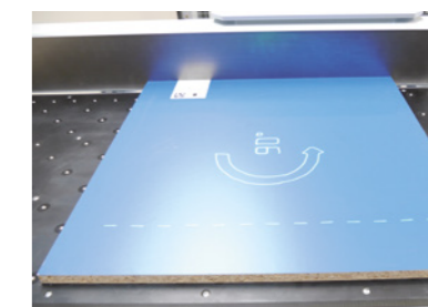
Interazione uomo-macchina: la sezionatrice reagisce alle azioni dell'operatore
