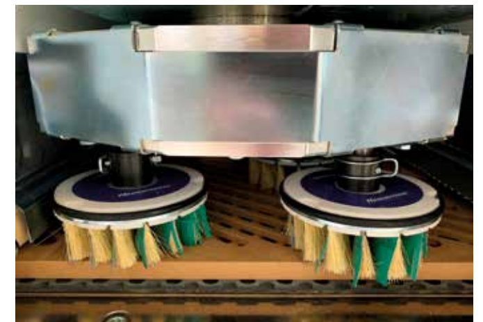
Pratique et vite accessible: l'unité de brosses circulaires DB-S montée sur rails
