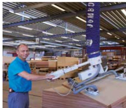
Grâce aux quatre points de préhension, le vide du tube de levage par le vide est transféré de façon optimale à la porte en bois massif lourde
