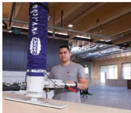
Pour les portes avec un poids normal, un JumboErgo avec une ventouse est suffisant.
