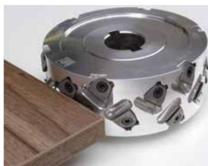
Le Diamaster WhisperCut EdgeExpert pour l'utilisation dans l'artisanat traditionnel ainsi que pour l'emploi industriel combine les avantages de la nouvelle gamme EdgeExpert avec ceux de la gamme existante (Foto: Leitz)
