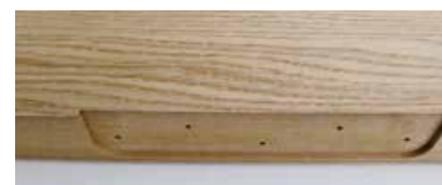
Enchâsser des fiches de porte sans pré-fraisage avec une fraise à rainurer du p-System
