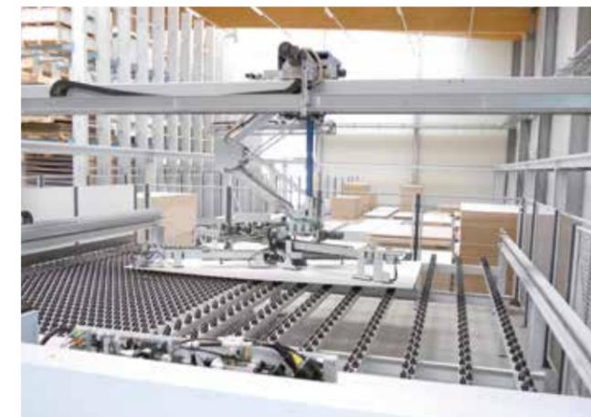
La combinaison scie-stockeur de la menuiserie Schneider AG à Pratteln est composée d'une scie HPP 350 et d'un stockeur à plat TLF 420. Ces deux machines sont faites, de par nature, l'une pour l'autre.
