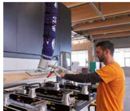
Pour l'alimentation d'une machine d'usinage CNC avec cadre de porte également, les collaborateurs misent chez Brunegg sur les tubes de levage par le vide de Schmalz.
