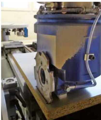
Unité de palpage de Benz avec barre de palpage et fraise à rainurer de Lamello
