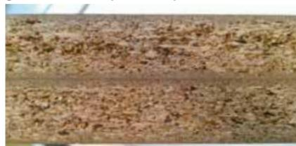
Haut: Un angle d'axe trop élevé génère des problèmes de qualité dans la couche centrale. Bas: Couche centrale après l'usinage avec une fraise à dresser Diamaster PLUS EdgeExpert (Foto: Leitz)
