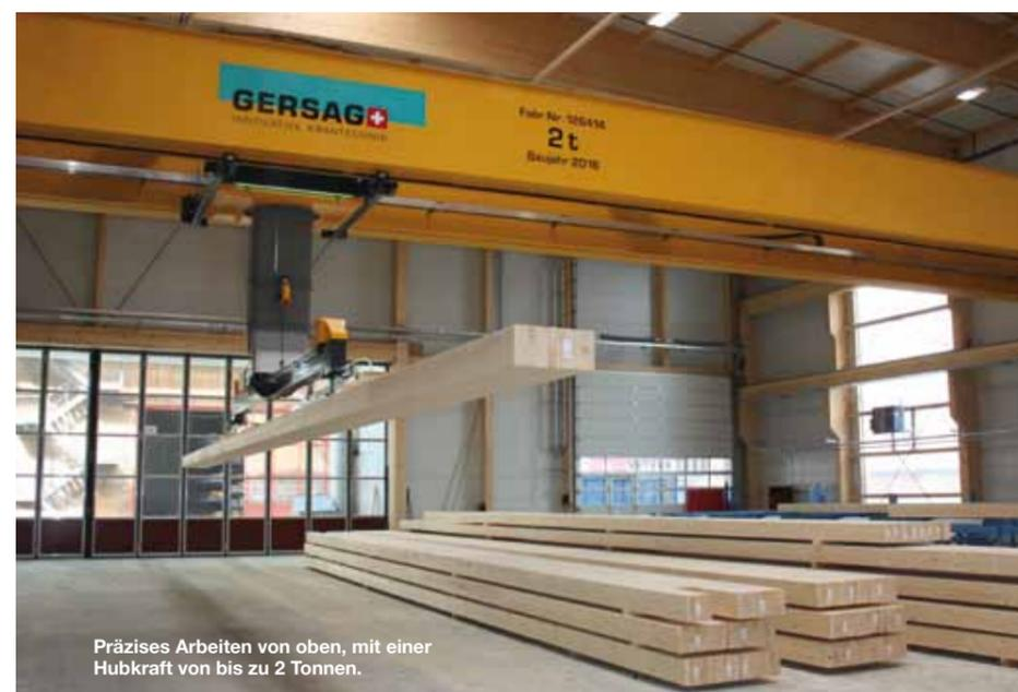
Präzises Arbeiten von oben, mit einer Hubkraft von bis zu 2 Tonnen.
