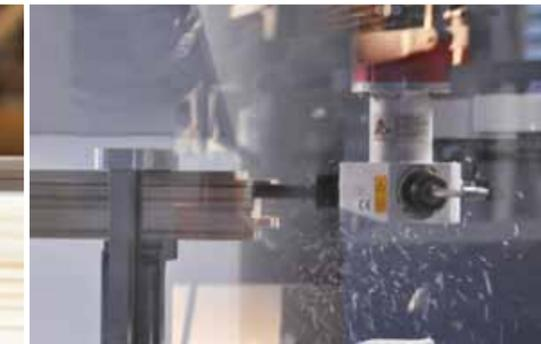
Der Zapfen und das Gegenstück werden mit einem Vollhartmetall-Fräser gefräst: Hier ist eine hohe Genauigkeit gefordert.
