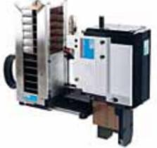
Autotec mit Wechselkassette für Heftklammern
