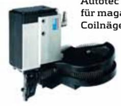
Autotec mit Großcoil für magazinierte Coilnägeln
