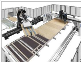
Im Zusammenspiel mit der Multifunktionsbrücke entsteht mit dem Roboter **FEEDBOT W-500** eine flexible, automatisierte Fertigungszelle.
