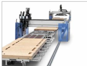
Elementtisch **BUILDTEQ A-500**, der eine große Auswahl an Optionen bietet und ein modulares Wachstum der Fertigung ermöglicht.
