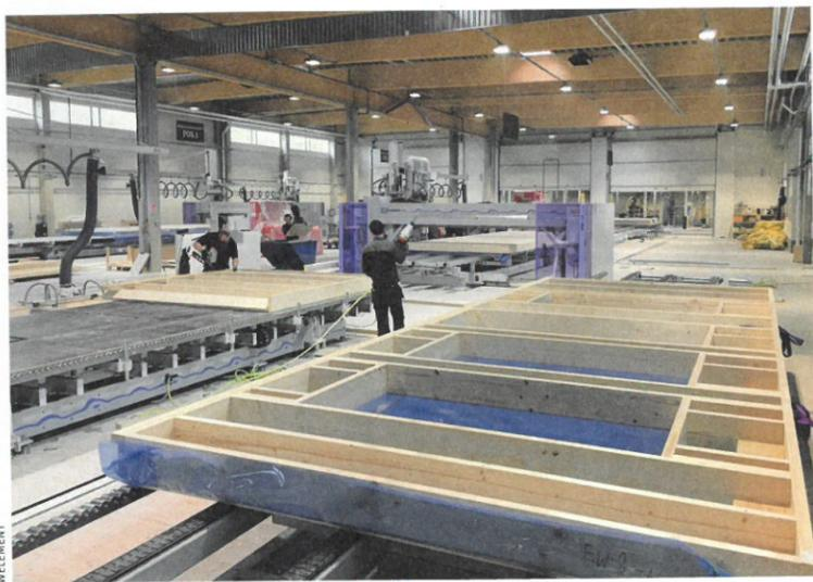
◀ Welement AS produziert alle Elemente mit zwei Weinmann Produktionslinien
