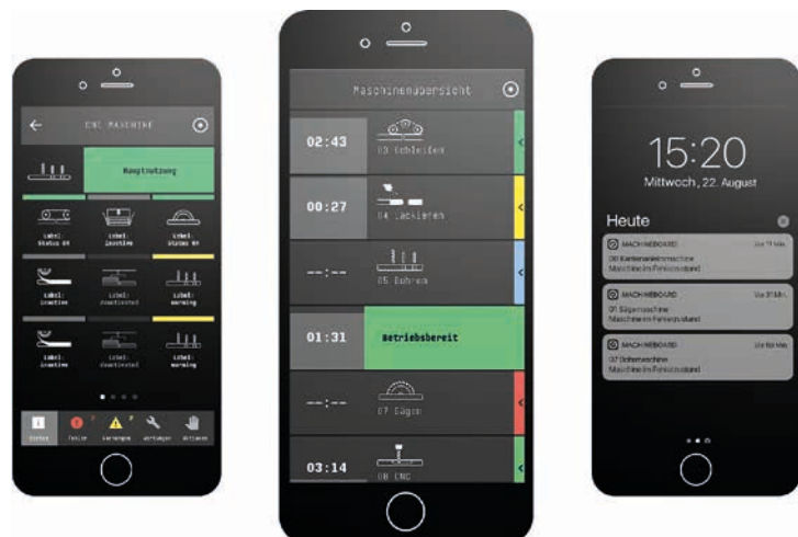
◀ Die tapio-App Maschineboard zeigt unter anderem den Betriebszustand von Maschinen und die Restlaufzeit von Fertigungsprozessen an
