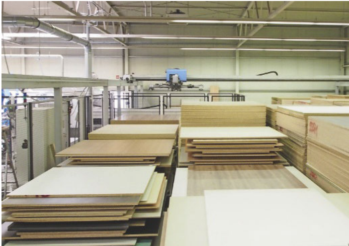
/ Blick in das vollautomatische Plattenlager. Dieses wurde mit Anschaffung der Sawtec B-300 FlexTec softwaremäßig auf den neuesten Stand gebracht.
