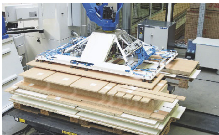
/ Tetris lässt grüßen: Die Stapelbildung im mannlosen Betrieb auf Paletten bzw. Hubtische erfolgt hochintelligent nach individuell definierten Parametern.
