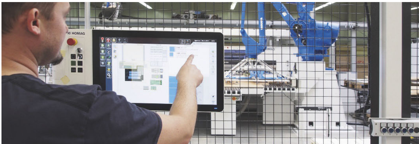
/ Die Bedienung der Sawteq B-300 FlexTec erfolgt komfortabel via PowerTouch-Bedienterminal. Leicht verständliche, grafisch unterstützte Dialoge machen es dem Maschinenbediener dabei denkbar einfach.
