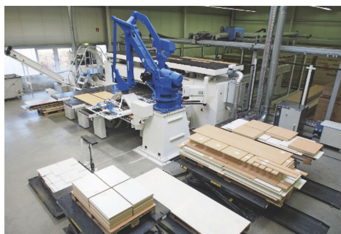
/ Die Sawtec B-300 FlexTec kann vollautomatisch oder manuell betrieben werden und verfügt über fünf Abstapelplätze. Im hinteren Bereich ist die automatische Abfallentsorgung mit Schüttelrinne, Kappautomat und Abfallsteigband zu sehen.
