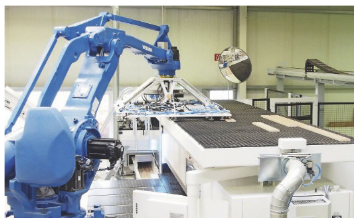
/ Teilepuffer oberhalb des Druckbalkens: Dort legt der Roboter die Teile bei Bedarf automatisch ab, um sie später abzustapeln oder erneut der Säge zuzuführen.
