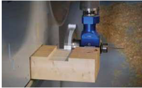
Beispiel für die Holzbearbeitung mit dem Scheibenfräser auf einer „BEAMTEQ B-660“-Anlage Foto: Weinmann
