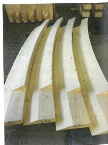
▶ Mit der Kompaktanlage wurden die Segmente für einen Kuppelfuß gefertigt
