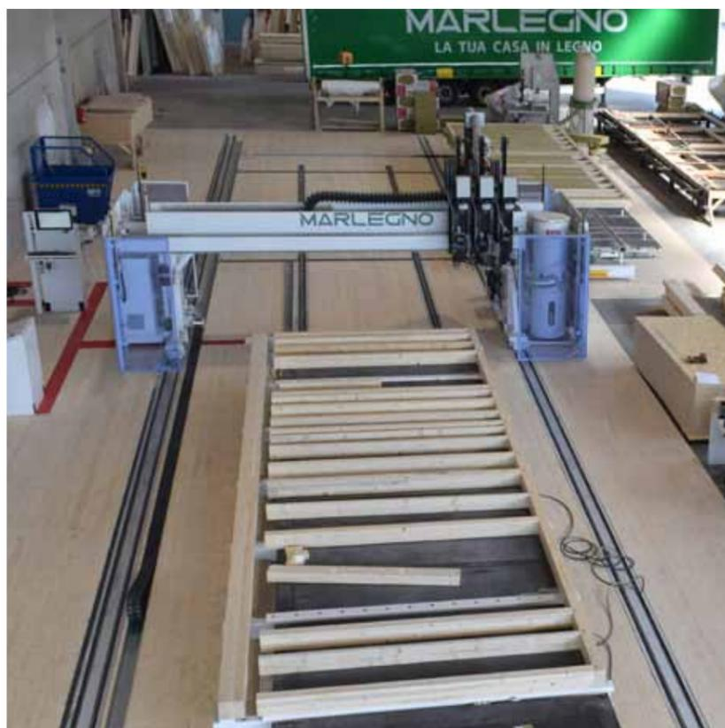
Schmetterlingswender mit Dach- und Deckenspannern und einer individuell konfigurierbaren Multifunktionsbrücke WALLTEQ M-380, die nicht nur für das Befestigen und Bearbeiten der Beplankung, sondern auch für den Plattenvorzugschnitt, die Massivholzbearbeitung, das Schrauben, Leimen etc. eingesetzt werden kann. Mit dieser Ausstattung eignet sich die Kompaktanlage bei geringem Platzbedarf (34 x 9 m) für die automatisierte Herstellung von Wand-, Dach-, Decken- und Sonderelementen in Losgröße 1.
