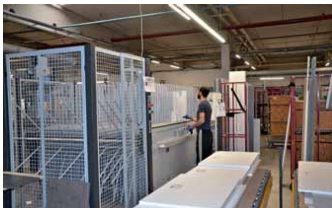
Oben: Die „KFR 610“ (heute: „Edgeteq S-800“) steht direkt hinter der Roboter-Säge und ist mit einer Material-Rückführung in der Lage, Teile vierseitig zu bekanten. Rechts: Eine Hubtraverse „TFU 820“ (heute: „Loopteq C-500“) legt die rückgeführten Teile für einen weiteren Durchlauf ab
