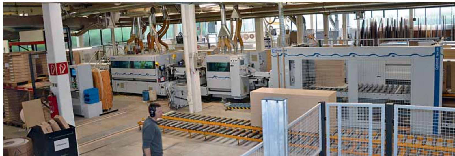
Parallel zur Format- und Kantenanleimmaschine „KFR 610“ (heute: „Edgeteq 5-800“) ist eine ältere „Flexline“-Anlage platziert, die nur Schmalteile produziert
