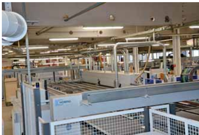
Oben: Die „KFR 610“ (heute: „Edgeteq S-800“) steht direkt hinter der Roboter-Säge und ist mit einer Material-Rückführung in der Lage, Teile vierseitig zu bekanten. Rechts: Eine Hubtraverse „TFU 820“ (heute: „Loopteq C-500“) legt die rückgeführten Teile für einen weiteren Durchlauf ab
