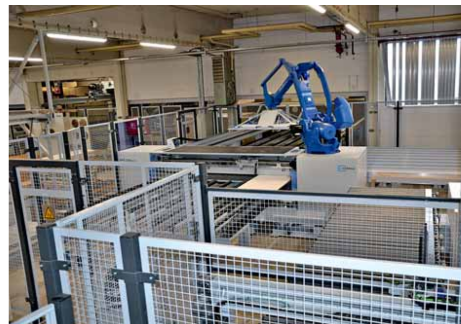
Hier läuft alles automatisch: Die Rohplatten werden vom Plattenlager (hinten links) über eine Rollenbahn der Roboter-Säge „Sawteq B-320 Flextec“ zugeführt
