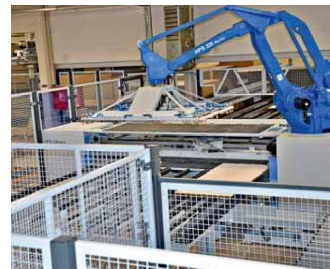
Hier läuft alles automatisch: Die Rohplatten werden vom Plattenlager (hinten links) über eine Rollenbahn der Roboter-Säge „Sawteq B-320 Flextec“ zugeführt
