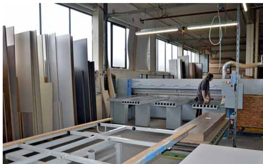
Die dritte Säge im Zuschnitt-Bereich ist eine manuell besetzte Druckbalkensäge „HPP 200“ – intern „Ferrari-Säge“ genannt
