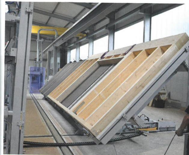
Mit dem Schmetterlingswender werden die Elemente in kurzer Zeit sicher und materialschonend gewendet.
