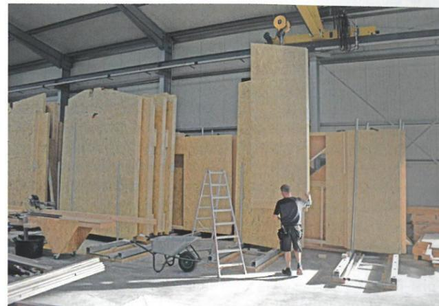
Montagetisch werden nun die Isolierung und Installationen eingebracht, bevor die zweite Elementseite geschlossen und ebenfalls mit der Multifunktionsbrücke befestigt und bearbeitet wird. Während auf dem zweiten Tisch das Element fertiggestellt wird, können die Mitarbeiter bereits auf dem ersten Tisch das nächste Riegelwerk erstellen. Mit der Investition in die WEINMANN-Kompaktanlage erhöhte Holzbindervoss seine Kapazitäten deutlich.
