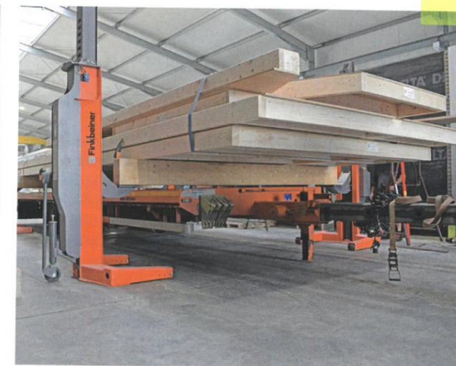
Die Elemente werden horizontal gelagert, verladen und transportiert.
