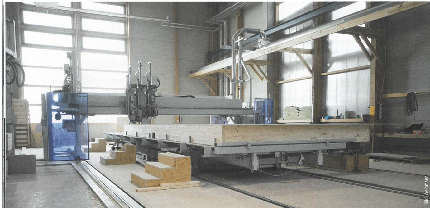
Die Kompaktanlage des Holzbaubetriebs besteht aus einer Multifunktionsbrücke und einem Zimmermeistertisch.
