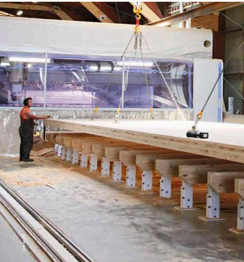
◀ Bis zu 350 mm dicke Massivholzelemente werden auf dem Massivholzportal WMP240 bearbeitet
