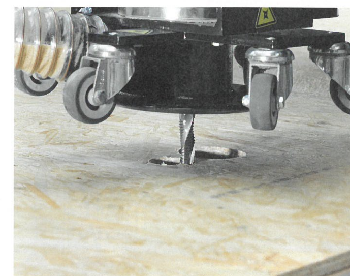
Mit dem Fräsaggregat bringt die Wallteq M-120 alle Ausschnitte und Öffnungen in die Elemente ein
