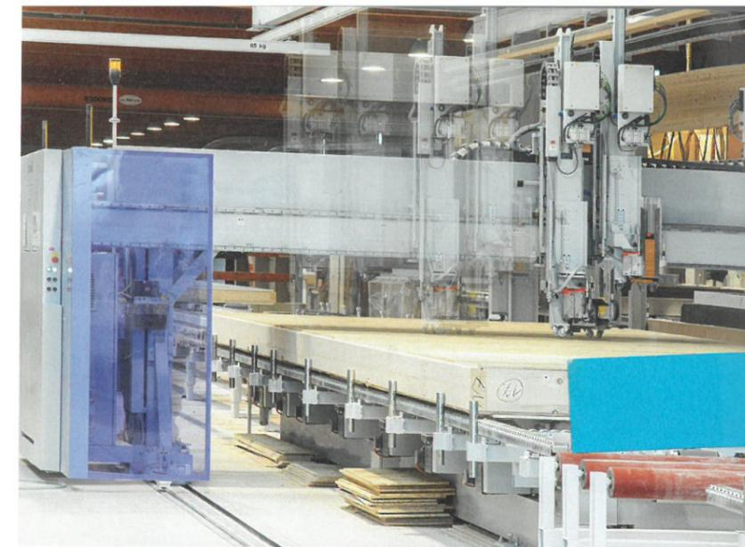
► Befestigen der Beplankung mit der Multifunktionsbrücke
