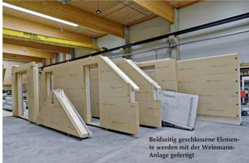
Beidseitig geschlossene Elemente werden mit der Weinmann-Anlage gefertigt
