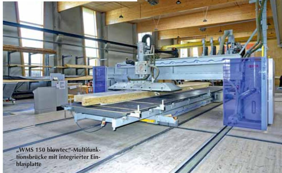
„WMS 150 blowtec“-Multifunktionsbrücke mit integrierter Einblasplatte
