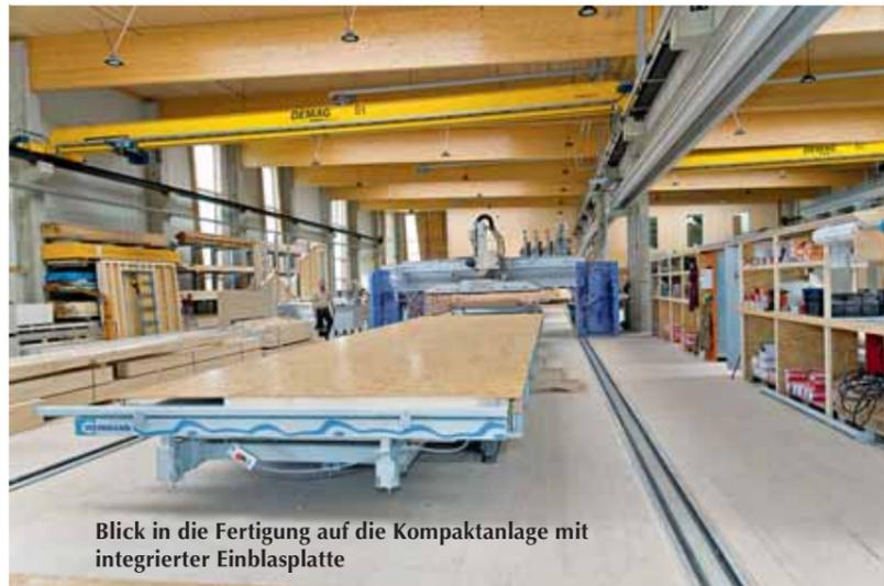
Blick in die Fertigung auf die Kompaktanlage mit integrierter Einblasplatte
