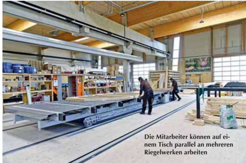
Die Mitarbeiter können auf einem Tisch parallel an mehreren Riegelwerken arbeiten
