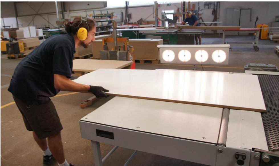
**Bild 5** Kontrolle mit Inspektionsleuchte nach dem Fertigschliff
