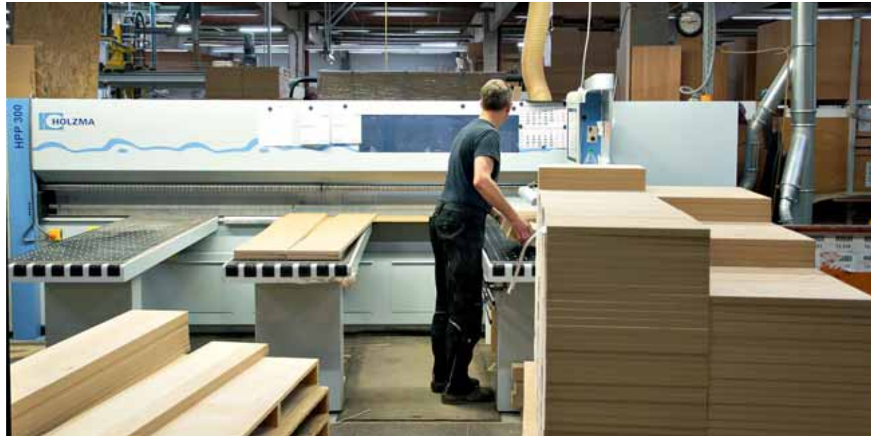
Die Plattenaufteilsäge „HPP 300“ sorgt für den exakten Zuschnitt
