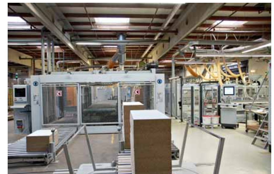
Anlage für höchste Ansprüche: doppelseitige Format-/Kantenanleimmaschine und Bohrmaschine mit beidseitiger Beschickung für große Losgrößen, als 4-Seiten-Linie aufgebaut
