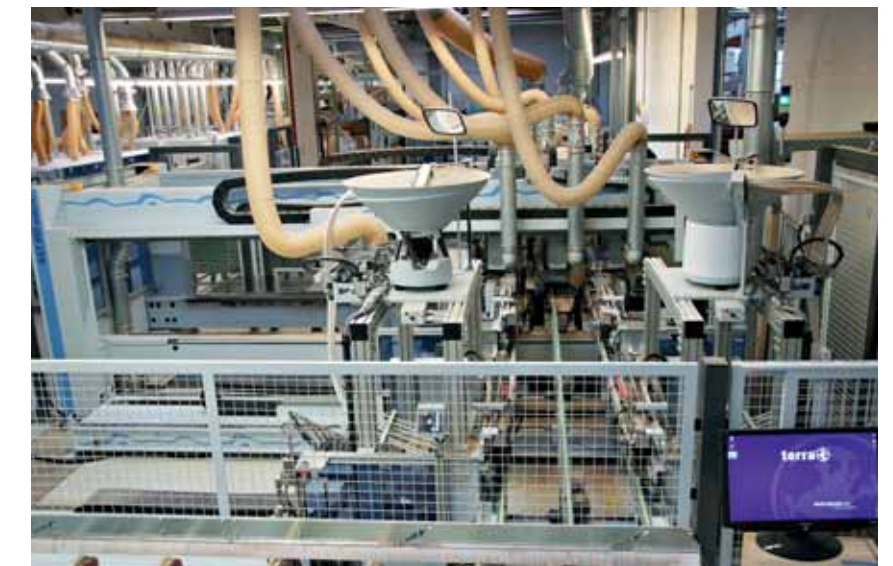
Die „BST800“ – mit bis zu 490 einzeln abrufbaren vertikalen Bohrspindeln, speziell für durchgehende Lochreihen bei sehr langen Schrankseiten – kann auch Stückzahl „1“
