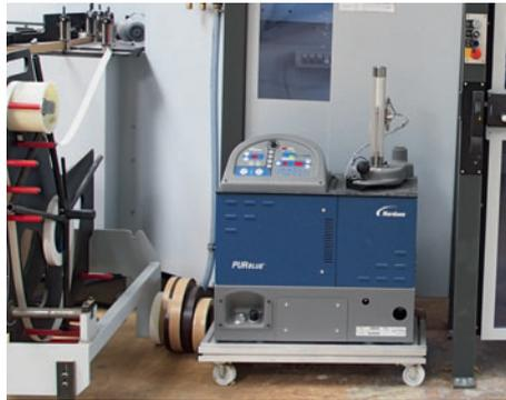
*/ Bei Ziefle Koch kommt ausschließlich PU-Kleber zum Einsatz. Hier im Bild die externe Aufschmelzeinheit*
