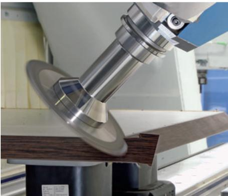
*/ Nach dem Anfahren der Kante wird mit einem Kappschnitt der Kantenüberstand entfernt.*
