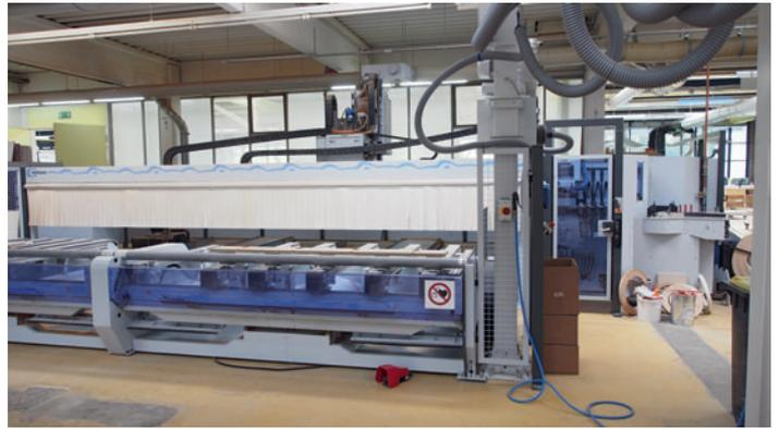
*/ Seit 2013 bei Ziefle Koch im Einsatz: Homag-CNC-Bearbeitungszentrum BAZ 722 mit PowerEdge-Verleimaggregat für Kanten bis 3 mm Dicke und 65 mm Höhe*
