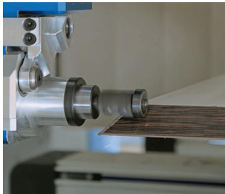
*/ Abschließendes Bündigfräsen des Überstandes. Hier: Werkstückecke mit Doppelgehrungskante*
