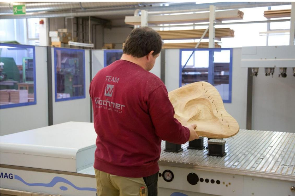
**Bild 2:** HOMAG hat das 3D-Modell mit dem Scanner erstellt, Wochner hat daraus mit Alphacam ein CNC-Programm generiert und die Reproduktion gefräst.
