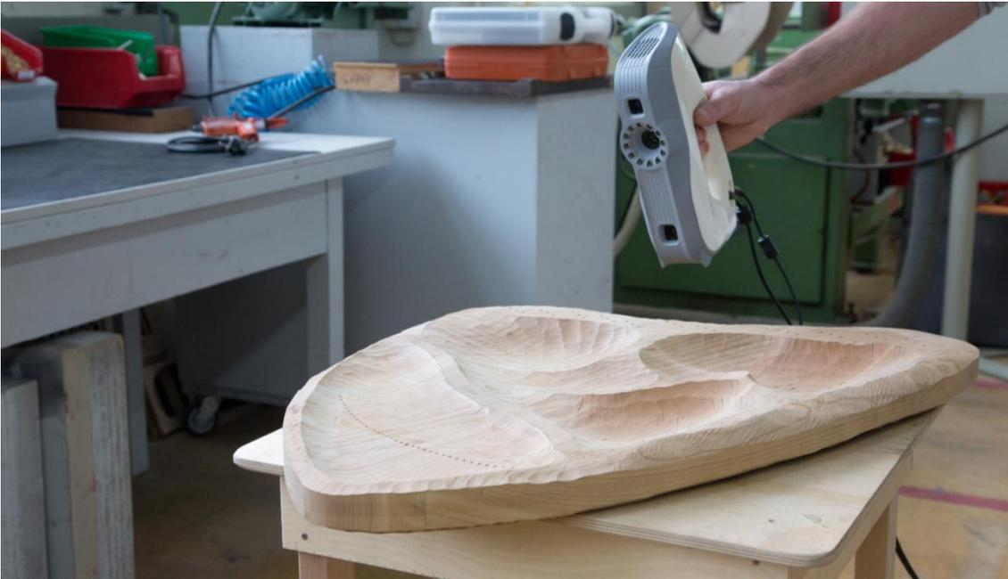
**Bild 1:** Ein Spezialist bei HOMAG führt einen Handscanner um ein Kunstwerk herum und erzeugt ein 3D-Modell für die Reproduktion auf der CNC.
