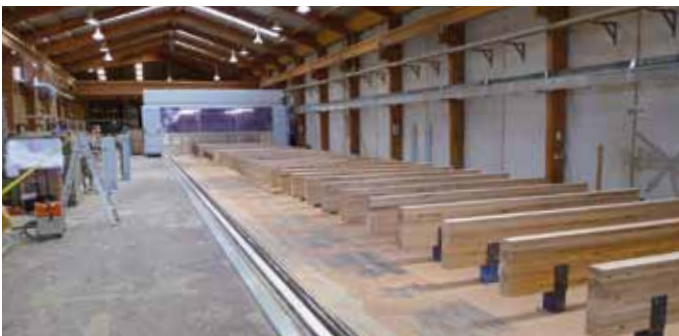
WEINMANN Massivholzportal - 4 m hoch, 9 m lang und 10 Tonnen schwer. WEINMANN solid wood portal - 4 m high, 9 m long, weighing 10 tons.
