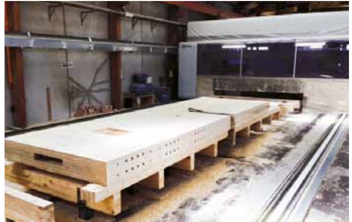
Leistungsstarkes Massivholzportal ermöglicht die Bearbeitung größter Holzdimensionen. The high-performance solid wood portal can process workpieces of extremely large dimensions.
