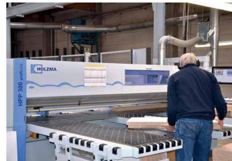
Links: Die Holzma-Säge schneidet die Teile so zu, dass die Kantenanleimmaschine sie direkt verarbeiten kann. Unten: Der Montagelinie ist eine „MLK“ vorgeschaltet, die CNC-gesteuert automatisch Leim in die Dübellöcher einspritzt, Bodenträger steckt sowie Kreuzplatten setzt und einschraubt
