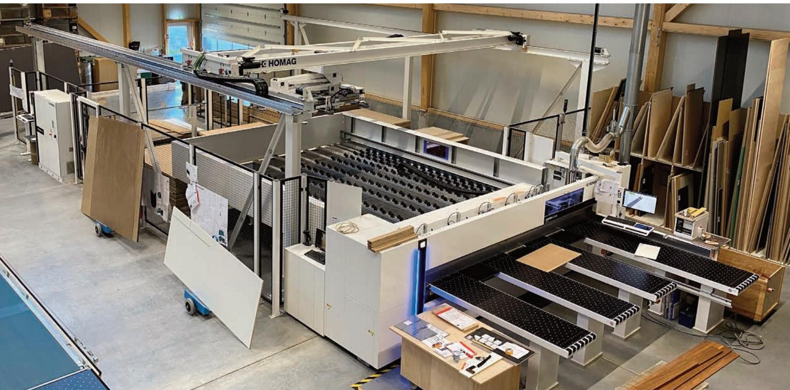
► Eine Säge-Lager-Kombination, ausgestattet mit dem materialManager Advanced, der für jedes Material die optimalen Bearbeitungsparameter vorgibt.
