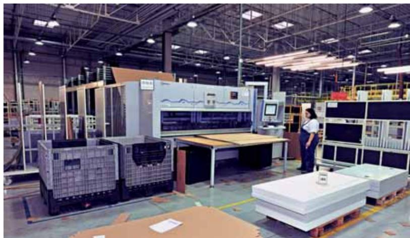
Die Kartons werden mit einer Kartonschneidemaschine mit 6-fach-Wechsler maßgeschneidert
