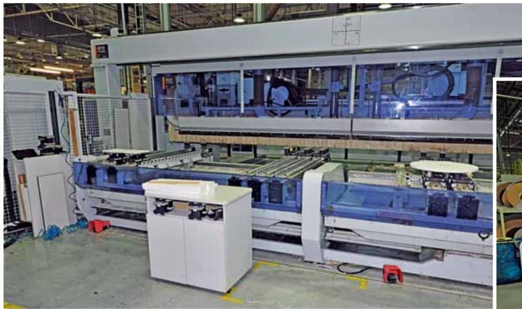
Oben: Laserverleimen von Formteilen auf dem Bearbeitungszentrum mit automatischem Plattenbeschicker
