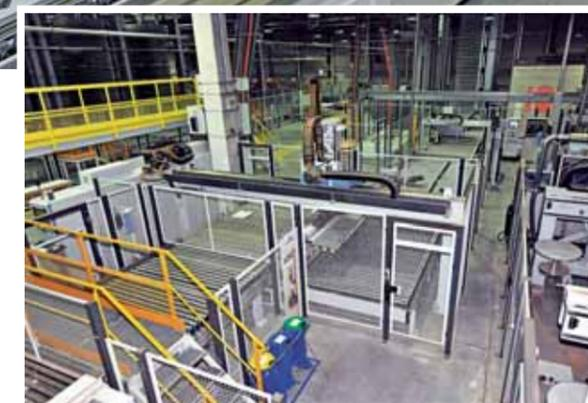
Die Quertraverse transportiert die zugeschnittenen Teile automatisch über den Barcode-Drucker in den Puffer
