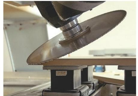
Das NN-Sägeblatt von Leuco erzeugt verleimfähige Fertigschnitte
