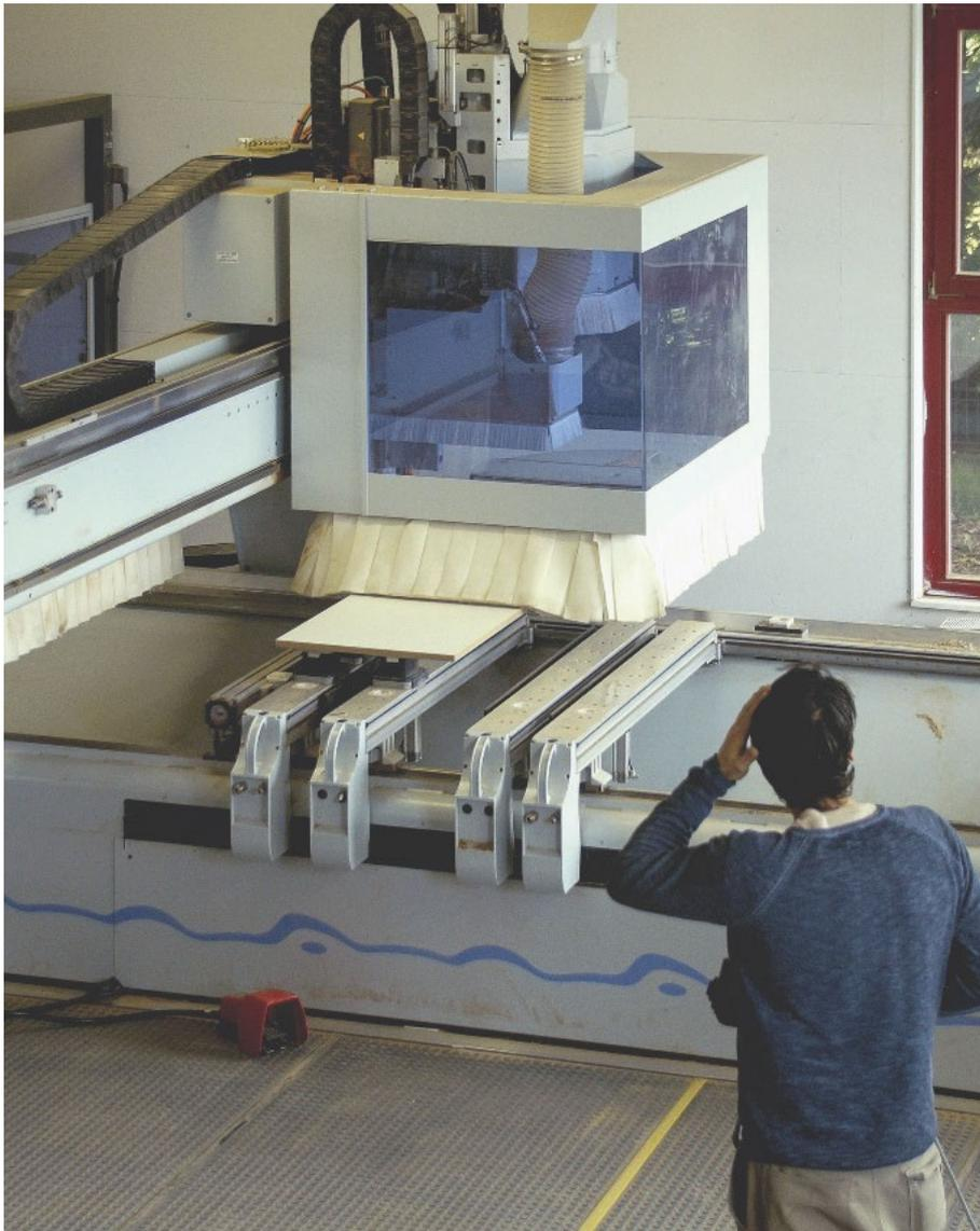
Benjamin Löw fertigt auf der 5-Achs-CNC Dreieckplatten mit Schifterschnitten
