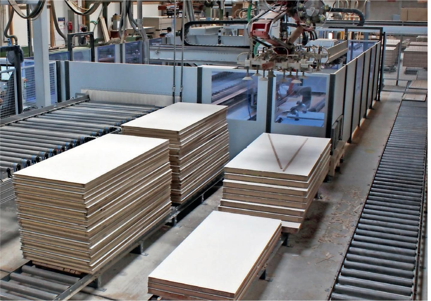
/ Speziell auf rationelle und flexible Türblattbearbeitung ausgelegt: Homag BOF 322 mit automatischer Zuführung und Abstapelung
