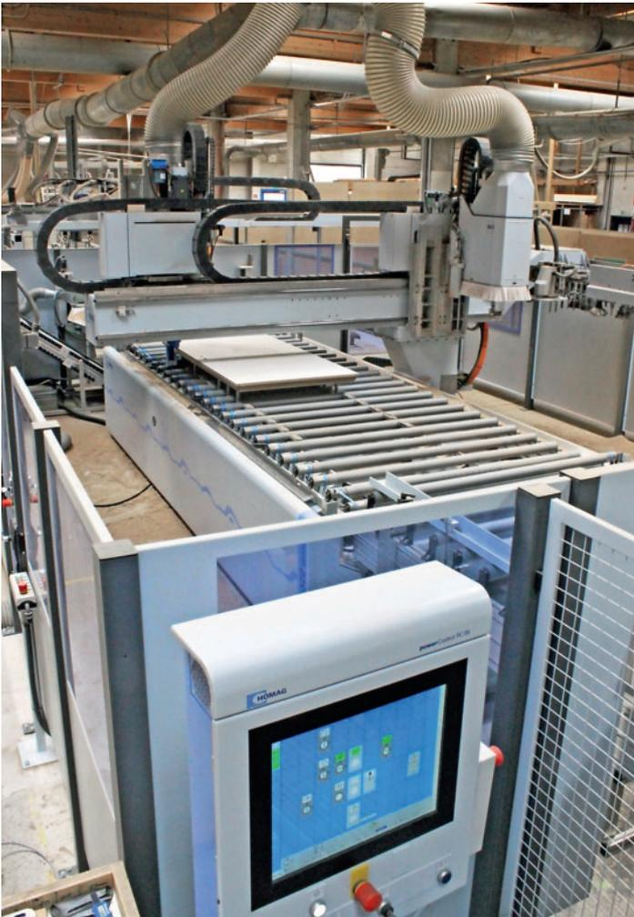
*Am Ausleger des Bearbeitungszentrums befinden sich zwei wassergekühlte und mit 24 000 min<sup>-1</sup> arbeitende Hauptbearbeitungsköpfe.*
