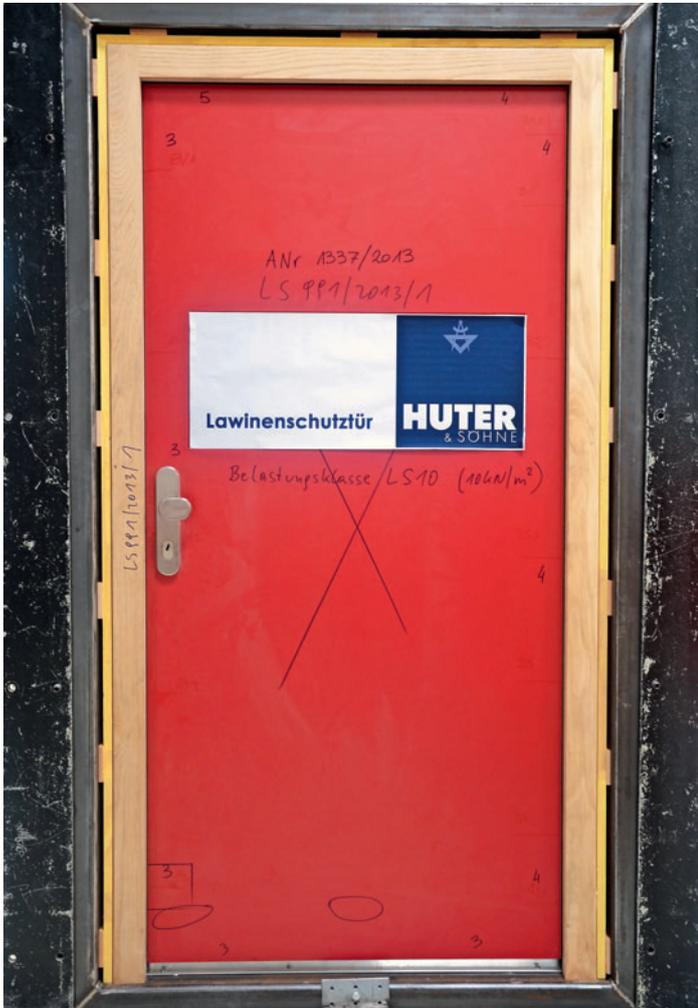
/ Hält richtig was aus: Solch eine Lawinenschutztür der Klasse LS10 widersteht einer Last von zwei bis vier Tonnen pro Quadratmeter Türfläche.
