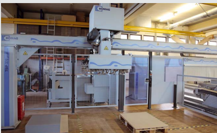
/ Der Portalbeschicker TBP ermöglicht den voll-automatischen Betrieb des Homag-BAZ 723.
