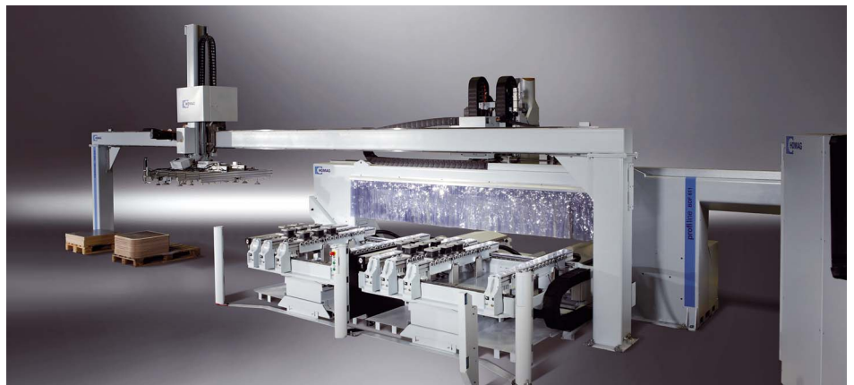
/ Durch die mögliche Länge von bis zu 15 m sind Linienportale die ideale Lösung für die Automatisierung von großen Portalbearbeitungszentren. Bei Doppelbelegung/Synchronbelegung der Maschine können ...
