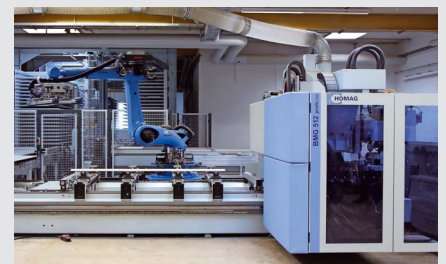
/ Der Roboter hinter dem BAZ ist linear verfahrbar. Im Zusammenspiel mit der automatischen ...
