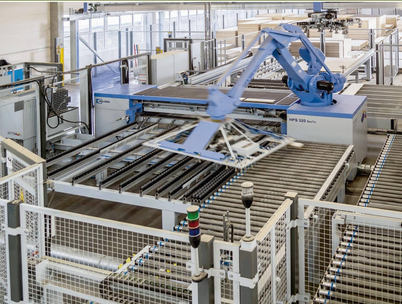
Lager, Säge und Roboter arbeiten Hand in Hand und liefern stetig in Losgröße 1 einen Zuschnitt nach dem anderen
