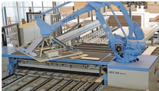
... und bringt es wieder zurück hinter die Säge, zum Querförderer, in den Teilepuffer oder auf die Auslaufbahn
