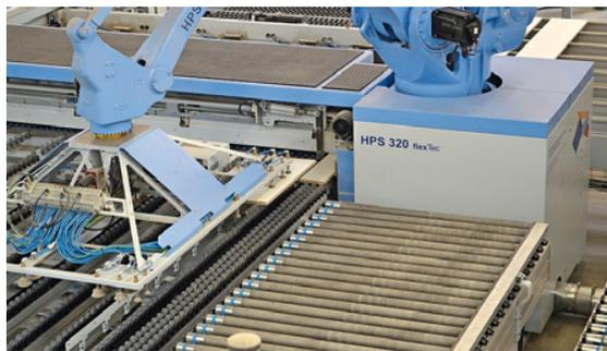
Mit der Saugtraverse ergreift sich der Roboter das, was die Säge abtrennt oder die Handrestebahn bringt ...
