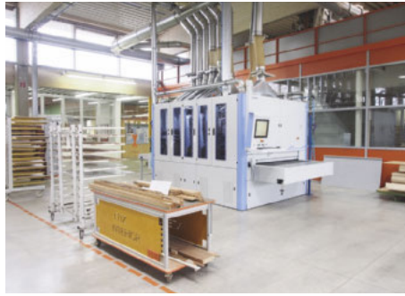
/ Ob furnierte, Massivholz- oder Lackoberflächen: Der Homag-Schleifautomat ist für alle Fälle gerüstet.
