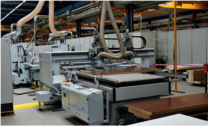
Teiledurchlauf im Referenzkantenfräser
