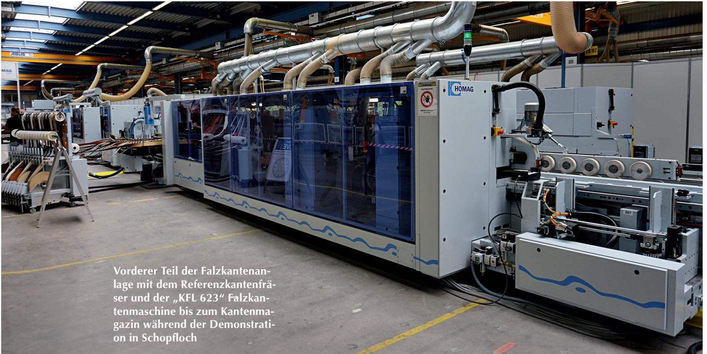
Vorderer Teil der Falzkantenanlage mit dem Referenzkantenfräser und der „KFL 623“ Falzkantenmaschine bis zum Kantenmagazin während der Demonstration in Schopfloch
