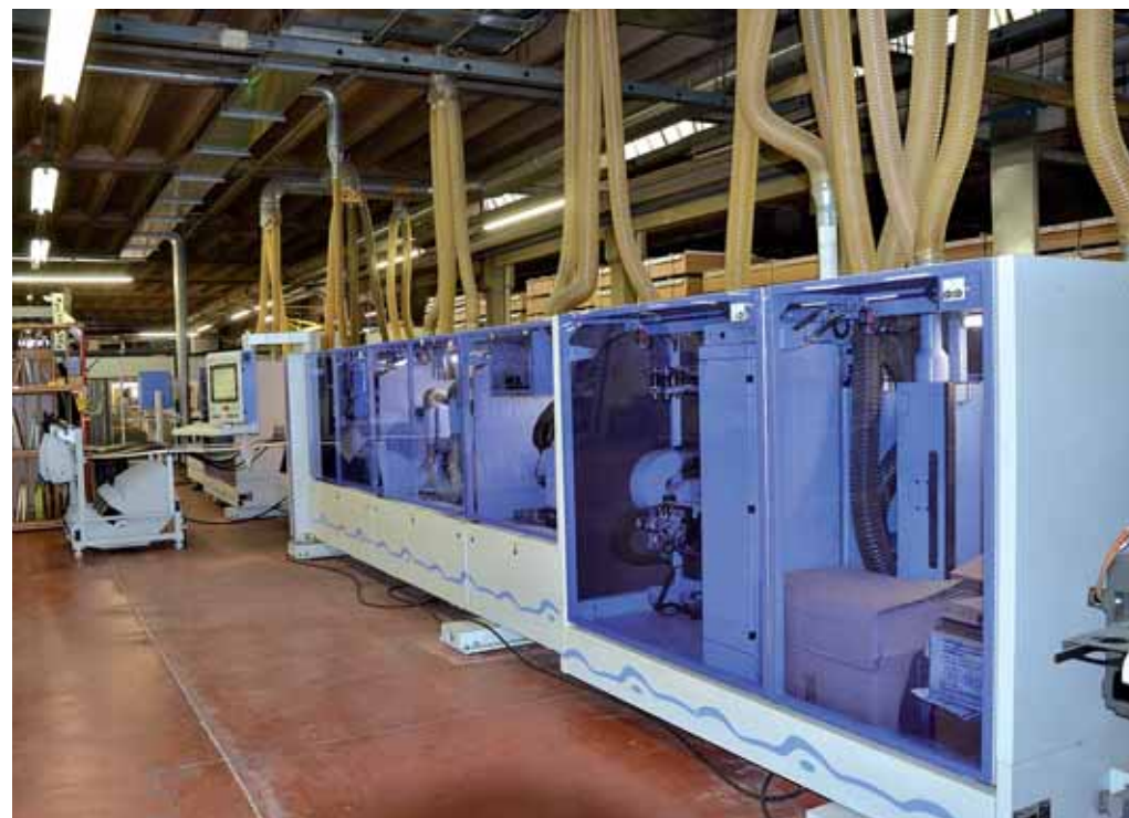
Die einseitige Format- und Kantenanleimmaschine „KFR 610 Power Line“ produziert bei Erba Mobil je nach Größe 700 bis 1 000 Teile pro Schicht
