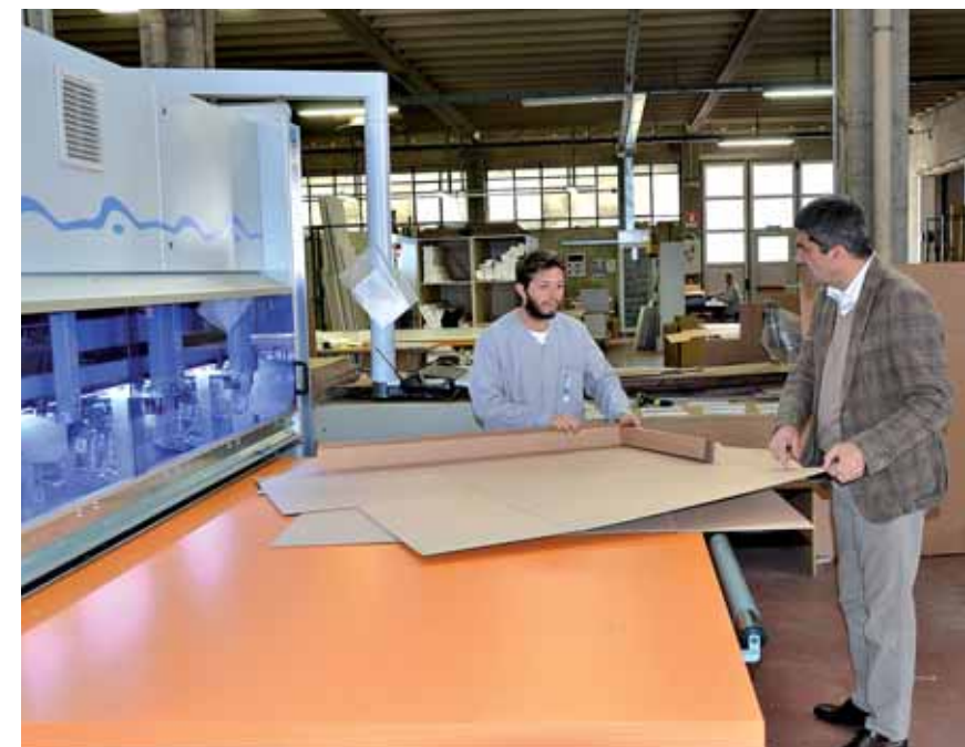
Links außen: Am Anfang der Losgröße-1-Anlage „KFR 610“ steht die manuelle Aufgabe der Werkstücke. Links: Die Verpackungsmaschine „VKS 250“ produziert 200 Kartons pro Tag. Oben: Maschinenbediener Matteo Erba zeigt Homag-Vertriebsmann Roberto Pardini einen fertigen Karton
