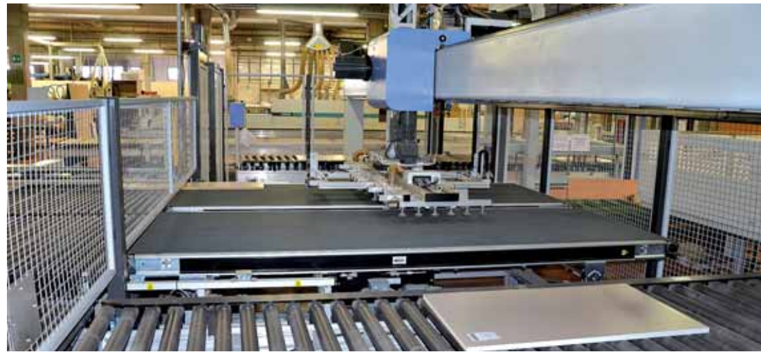
Eines der beiden Portale des „TFU 820“, in diesem Fall das erste Beschickportal, das die Teile von der Zuführung oder der Rückführung aufnimmt und es der nächsten Bearbeitung zuführt
