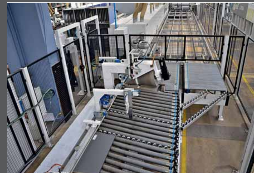
Die Kantenbearbeitungsmaschine ist einseitig konzipiert, um flexibel kleine und große Teile hintereinander bekanten zu können
