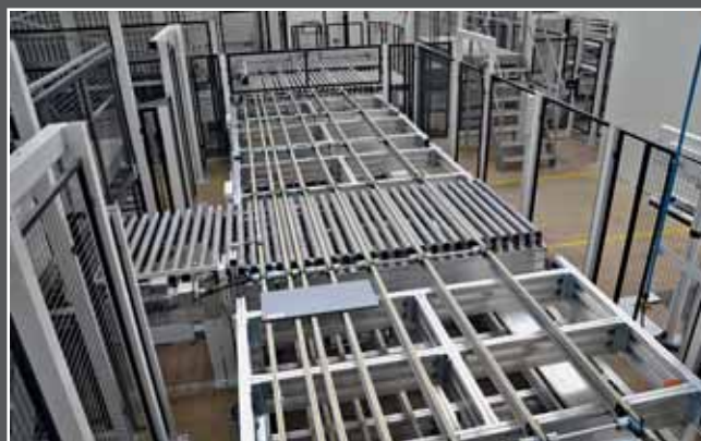
Von links oben: Wie in der Automobilindustrie: Automation von vorne bis hinten. Rechts der Sortierspeicher, links hinten die Formatstraße. Der Etikettendrucker mit integriertem Kontrollscanner am Auslauf kennzeichnet alle Teile vollautomatisch, wobei jede Säge einen eigenen Drucker hat. Rollenbahnen und Transportbänder: Die gesamte Fertigung bei Duravit ist vollautomatisch organisiert und durch zwei Meter hohe Schutzgitter gesichert
