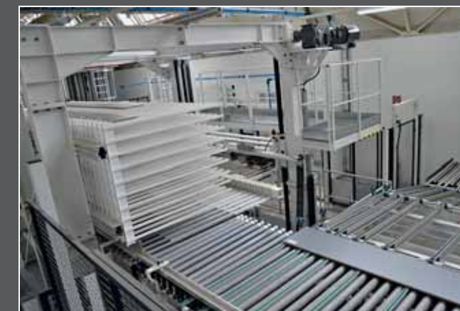
Bauteile, die eine Kante erhalten, werden in einem Lagenpeicher „Sorteq H-600“ zwischengelagert, der als Entkoppelungspuffer fungiert
