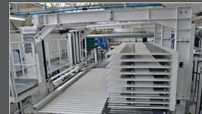
Nach dem Bekanten gehen die Bauteile in einen 4-fach-Sortier-Puffer „TLB 210“ oder aber direkt zur Abstapelung
