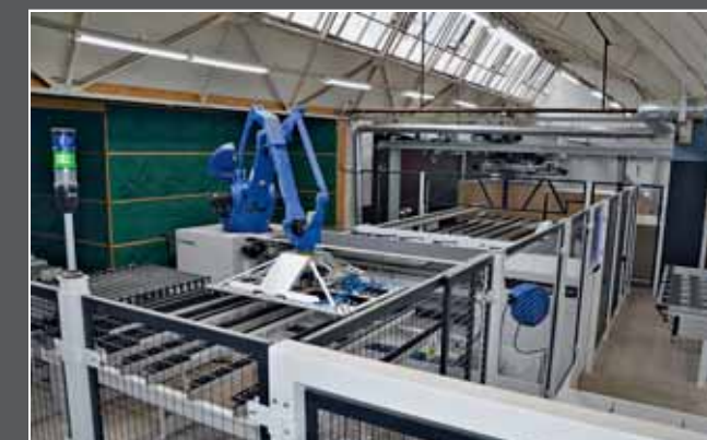
Die Materialpuffer sind so dimensioniert, dass zwei Drittel der Kapazität bis in den Keller reichen
