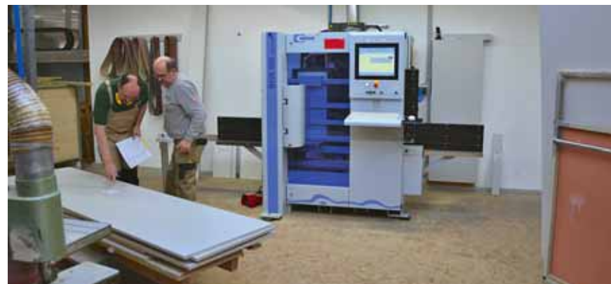
Das Bearbeitungszentrum „BHX 055 Optimat“ von Weeke hat sich bei Daxenberger bestens eingeführt. Es bohrt und fräst sämtliche Möbelteile
