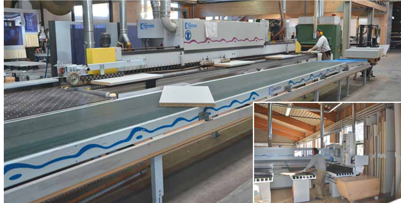
Im Zuschnitt startet die vernetzte Schreinerei die Organisation ihres Materialflusses mit der Plattenaufteilsäge „HPP 300“ von Holzma und dem Flächenlager „TLF 211“ von Homag Automation
