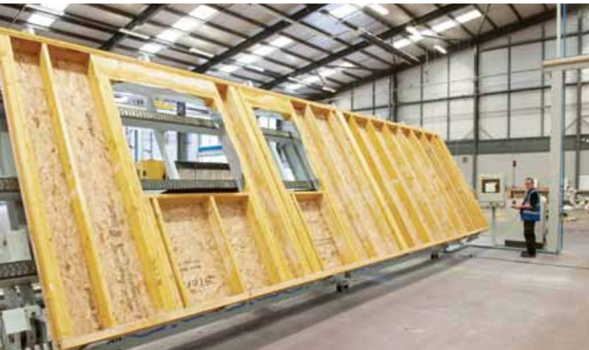
Mit dem Schmetterlingswender wird das Element gewendet, um die zweite Seite bearbeiten zu können. The butterfly turning table turns the element, so that the second side can be processed.
