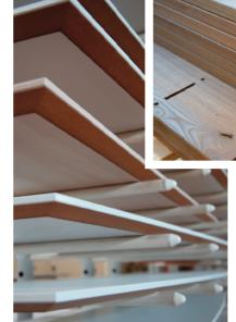
Dank der Fünf-Achs-Technologie kann Bosch Werkstücke in ieder Geometrie bearbeiten und mit "Lasertec"-Kantenverleimtechnik Bauteile wie beispielsweise Konferenztischplatten (links) mit Nullfugenoptik herstellen.
