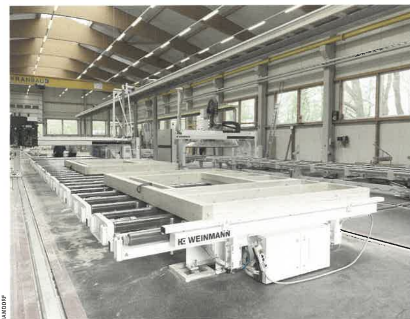
◀ Links zu sehen ist die Wallteq M-120 mit der die erste Elementseite bearbeitet wird. Daneben steht die Wallteq M-310 insuFill die das Einbringen des Dämmmaterials übernimmt
