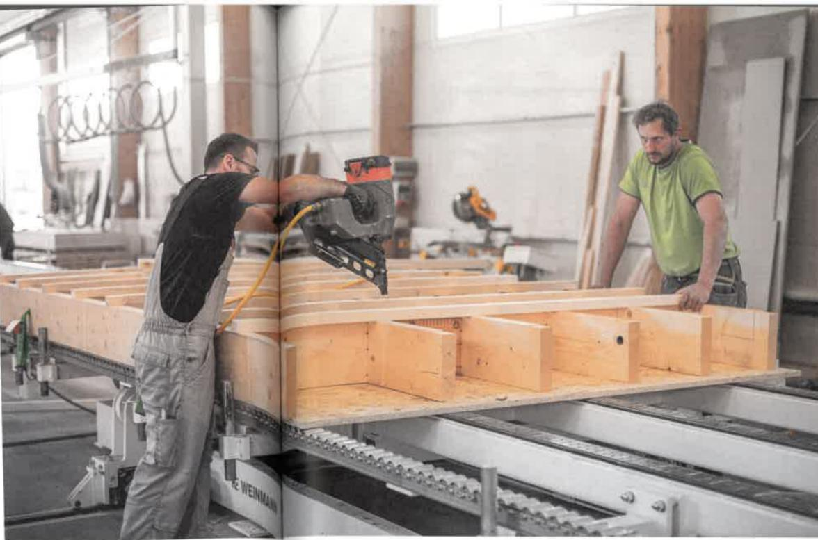
◀ Auf der Fertigungsanlage können neben Wand- auch Dach- und Deckenelemente produziert werden
