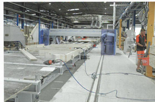
Unterschiedliche Wandaufbauten können mit der sehr flexiblen Linie rationeller als bisher gefertigt werden, Schrägelemente sind problemlos möglich.
