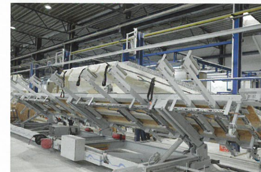
Mit dem Wendetisch werden die Elemente gewendet, aufgestellt und direkt in den angrenzenden Puffer übergeben.
