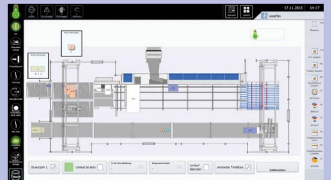
Um die Steuerung der Kantenbearbeitungslinie kümmert sich woodFlex. Die Software bietet einen vollständigen Überblick über die Produktion.
