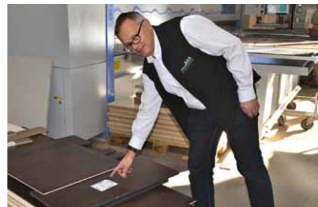
Bernhard Daxenberger deutet auf das Barcode-Label – einen entscheidenden Organisations-Faktor der vernetzten Fertigung
