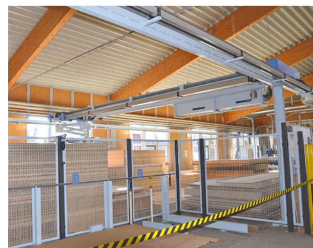
Le stockeur automatique TLF 211 est capable de prendre en charge et de gérer toutes dimensions de panneaux jusqu'à 5 600 x 2 200 mm.
